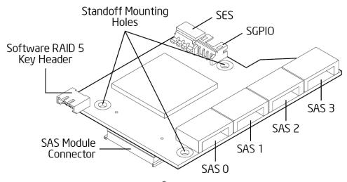
Figure 8. Intel<sup>®</sup> SAS Entry RAID Module
