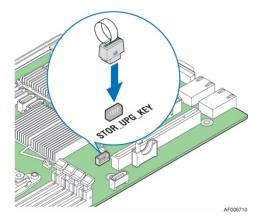
Figure 28. Intel<sup>®</sup> RAID C600 Upgrade Key
