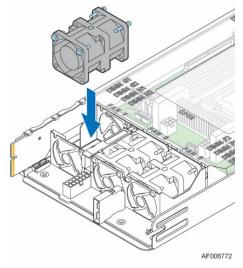
Figure 26. Compute Module Fans
