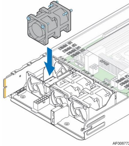
Figure 26. Compute Module Fans
