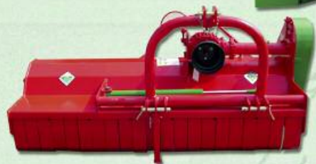
Desbrozadora Trituradora para restos vegetales con enganche desplazable hidráulico
