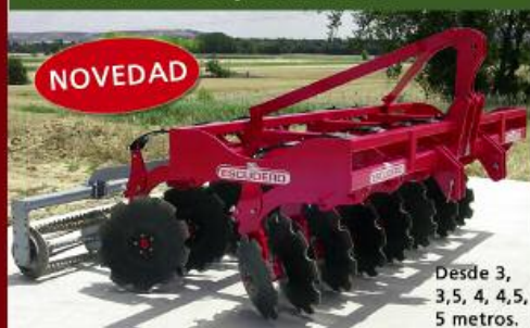
GRADA RAPIDA DE BALLESTA con doble disco por brazo.
