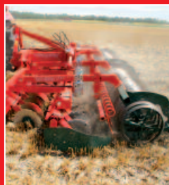
VN TerraDisc Grada de disco corta de 3 hasta 6 m de ancho de trabajo
