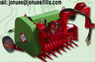
Trituradora con alimentador especial sarmientos con enganche desplazable para tractores zancudos
