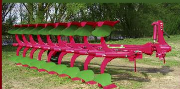
PREPARADOR de 4 filas. Desde 4 m a 7 m de ancho, con doble chasis y doble brazo.
