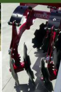
GRADA RAPIDA DE BALLESTA con doble disco por brazo.
