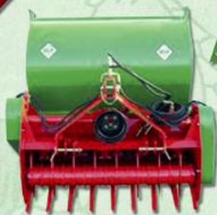
Trituradora a martillos con alimentador hidráulico y tolva de recogida de material
