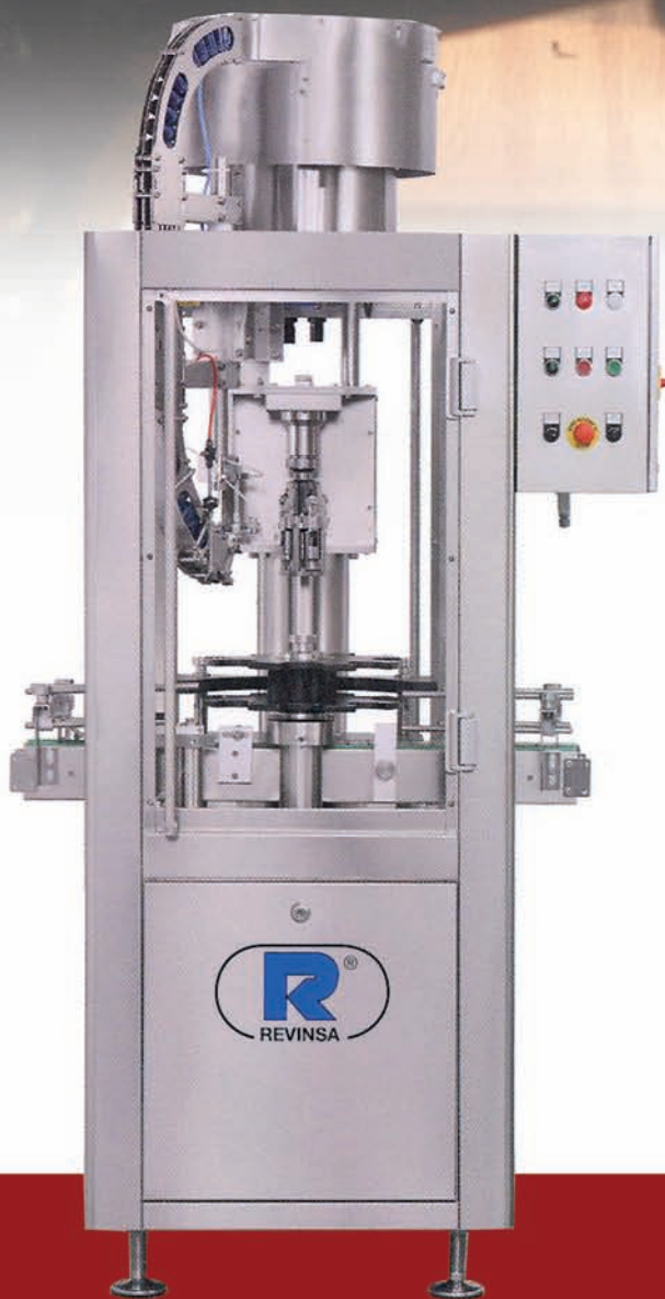
TP-2000 tapadora para cápsulas de aluminio 2.000 botellas/hora
