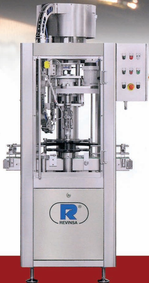
TP-3000 tapadora para cápsulas de aluminio 3.000 botellas/hora
