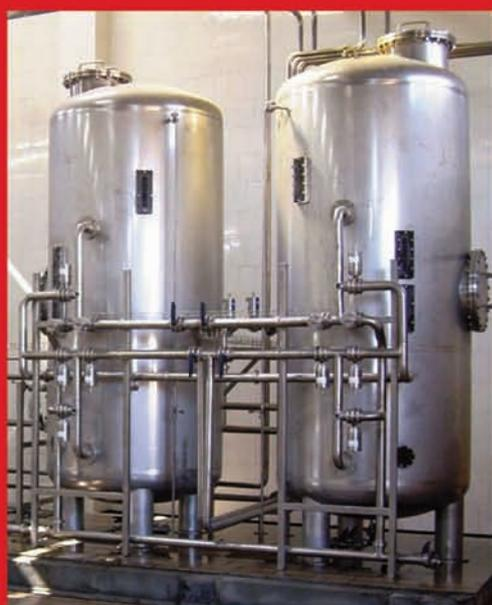
En conclusión, la estabilización tartárica por intercambio iónico es una técnica eficiente que asegura la eliminación del potasio y el riesgo de sobresaturación del bitartrato potásico mediante un proceso productivo seguro, económico y que permite conservar niveles elevados de acidez, un punto muy importante en particular con los vinos carentes de esta componente.
