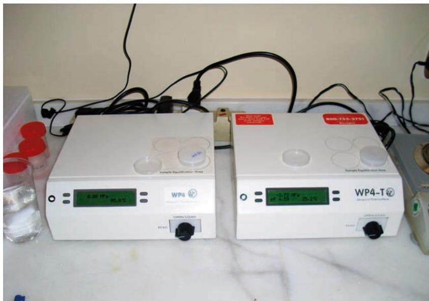
Figura 1. Water Activity Meters realizando lecturas de potencial hídrico foliar a temperatura ambiental (WP4) y a temperatura prefijada por el usuario (WP4-T) en condiciones estables de laboratorio.
