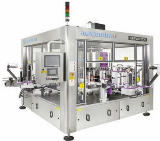
El sistema servotech permite el aplicado de etiquetas autoadhesivas, etiquetas de papel en adhesivo frío y etiquetas tanto de papel como de OPP en adhesivo termofusible, sobre diversos tipos de envases, formas y materiales. Por ejemplo, sobre vidrio, plástico y metal. En un mismo envase se pueden aplicar varios tipos de decoraciones, de una a varias etiquetas según su composición.
