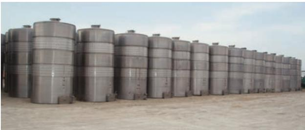
MMG Maquinaria dispone de depósitos de 5.600, 10.000 y 50.000 litros para vino fabricados en inoxidable Aisi 316 y 304. Estos depósitos constan de 2 a 4 camisas para frío, toma de muestras, medidor, boca de hombre arriba y abajo y dos salidas de producto.
