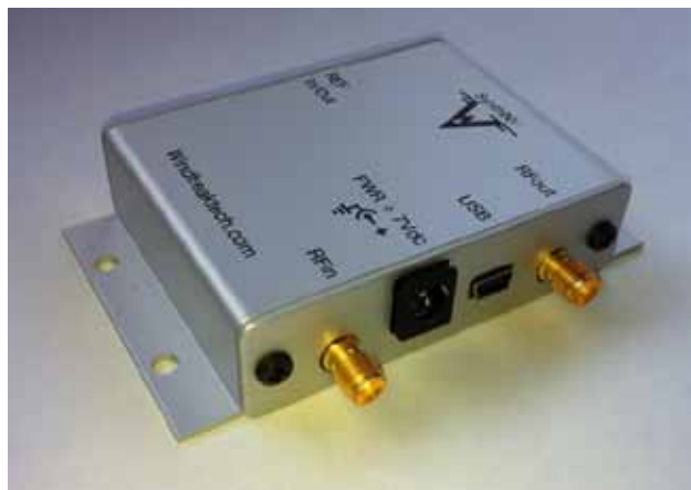
图5 Windfreak Technologies模型SynthNV射频发生器是USB控制的，并能在35MHz到4400MHz频段调谐。它还基于辐射敏感度标准IEC 61000-4-3，在1KHz以调幅形式调制射频输出
