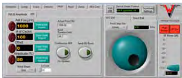
图7 射频扫描功能的控制面板允许设置低端和高端频率限值，步长从1KHz到100MHz
