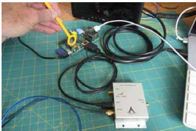
图13 采用Windfreak Technologies 提供的SynthNV评估Raspberry PI嵌入式处理器
