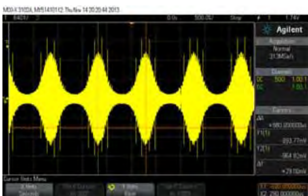
图8 来自SynthNV的80%幅度调制射频输出显示了一些周期性的毛刺。虽然设计者在研究这个问题，但是我不认为这对抗扰度故障排查而言是多大的问题
