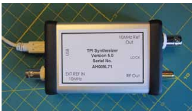
图3 Trinity power公司提供的TPI频率合成器，大约为2到3.5英寸，能够在35MHz到4400MHz频段产生+17dBm的输出
