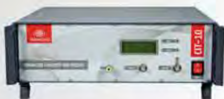
传导抗扰度测试系统 Type CIT-10, 10 kHz - 400 MHz, 满足 IEC/EN 61000-4-6, ISO 11452-4 及 MIL-STD 461E
