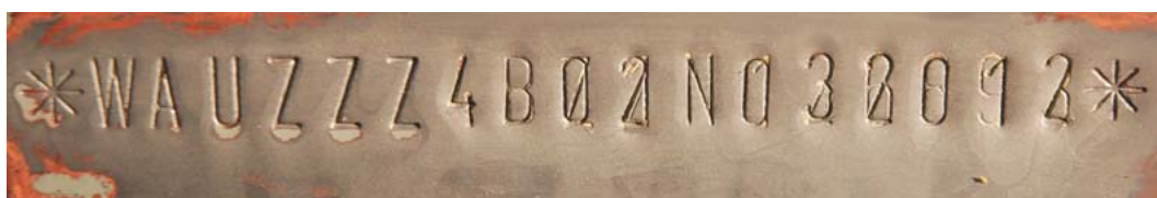
Números de bastidor restaurados, antes y después.
