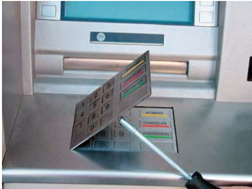
Teclado falso superpuesto al original.
