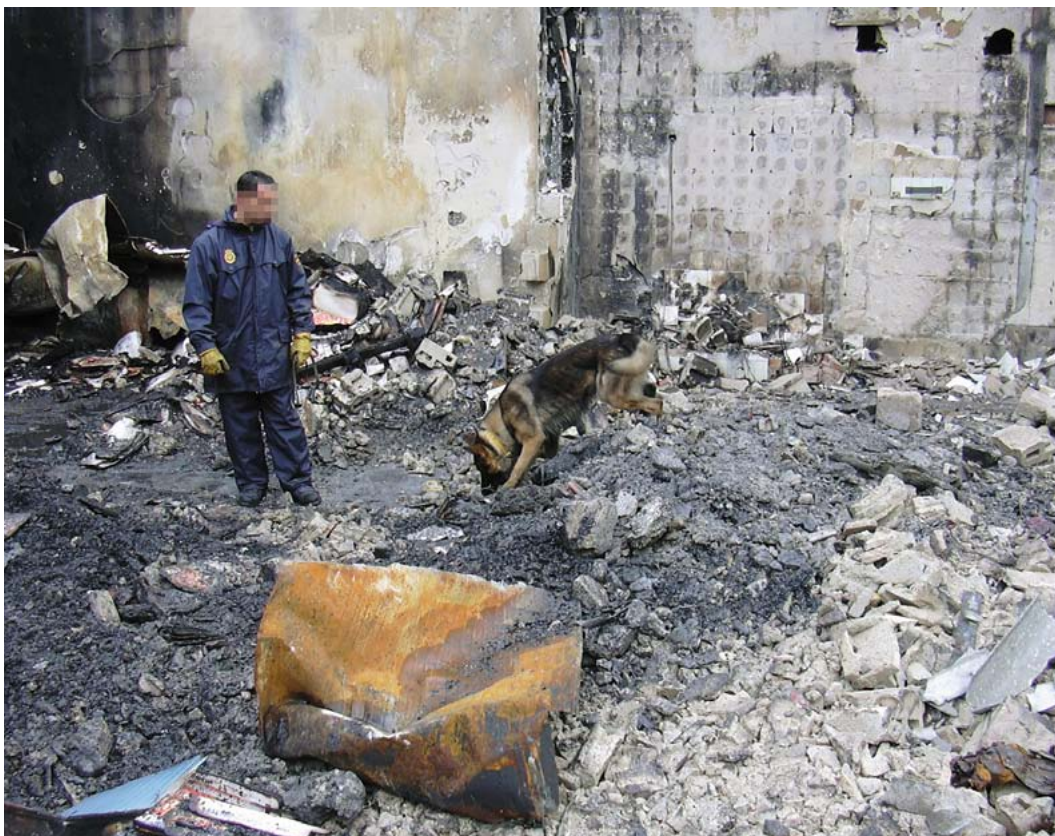
Apoyo de los perros DAF (detectores acelerantes del fuego) en la investigación de incendios.
