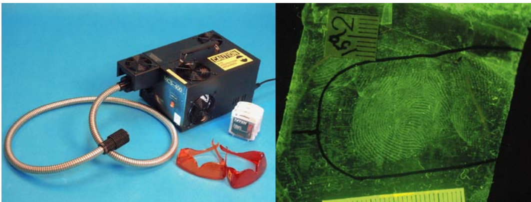
Visualización con luz forense de una huella revelada con cianoacrilato y posteriormente tintada con flavina.
