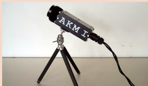
Eine Bildverstärkerkamera vom Typ AKM1. Eingebaut ist ein lichtstarkes Objektiv, eine Bildverstärkerröhre der zweiten Generation und ein Videokameramodul aus dem Elektronikversand. Foto Sirko Molau.
