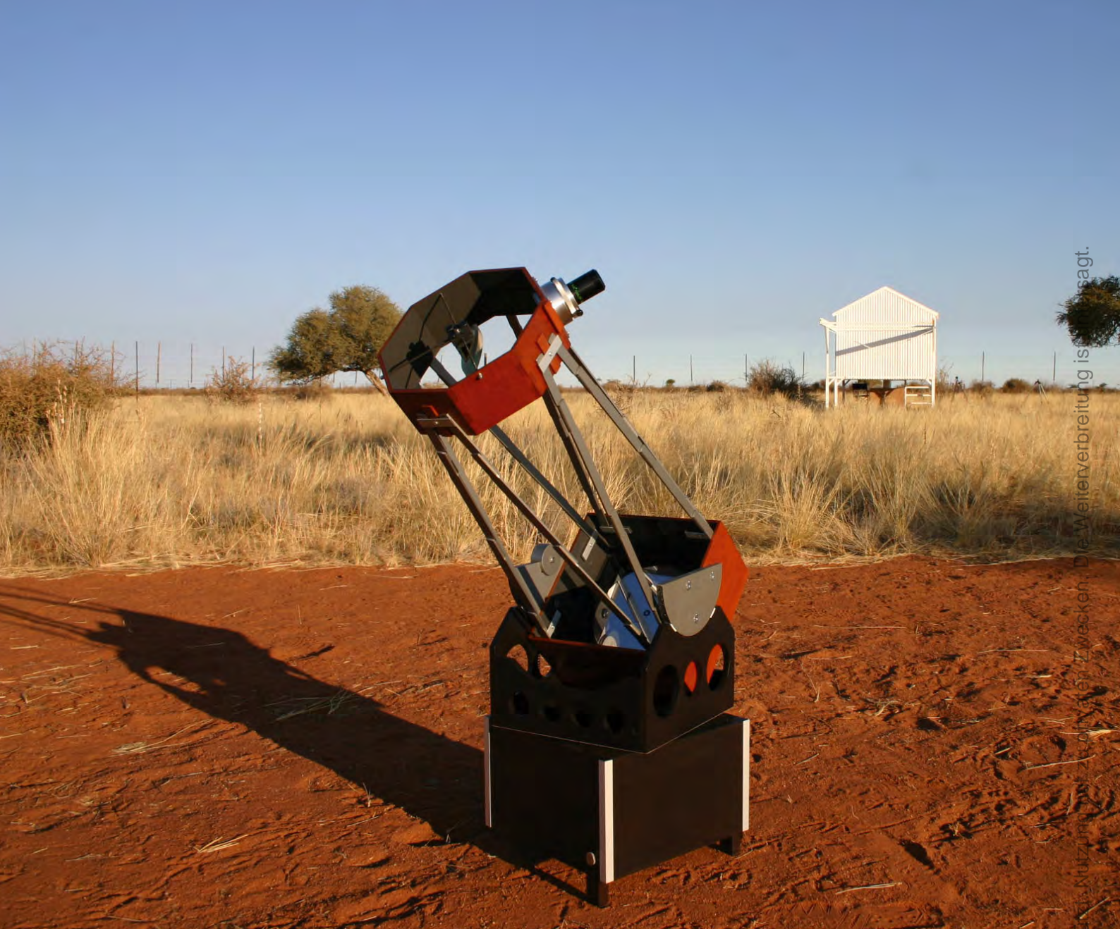
Abb. 1: Der 200mm-Reisedobson in aufgebautem Zustand. Die Transportkiste wird umgedreht und dient als Standsockel.
