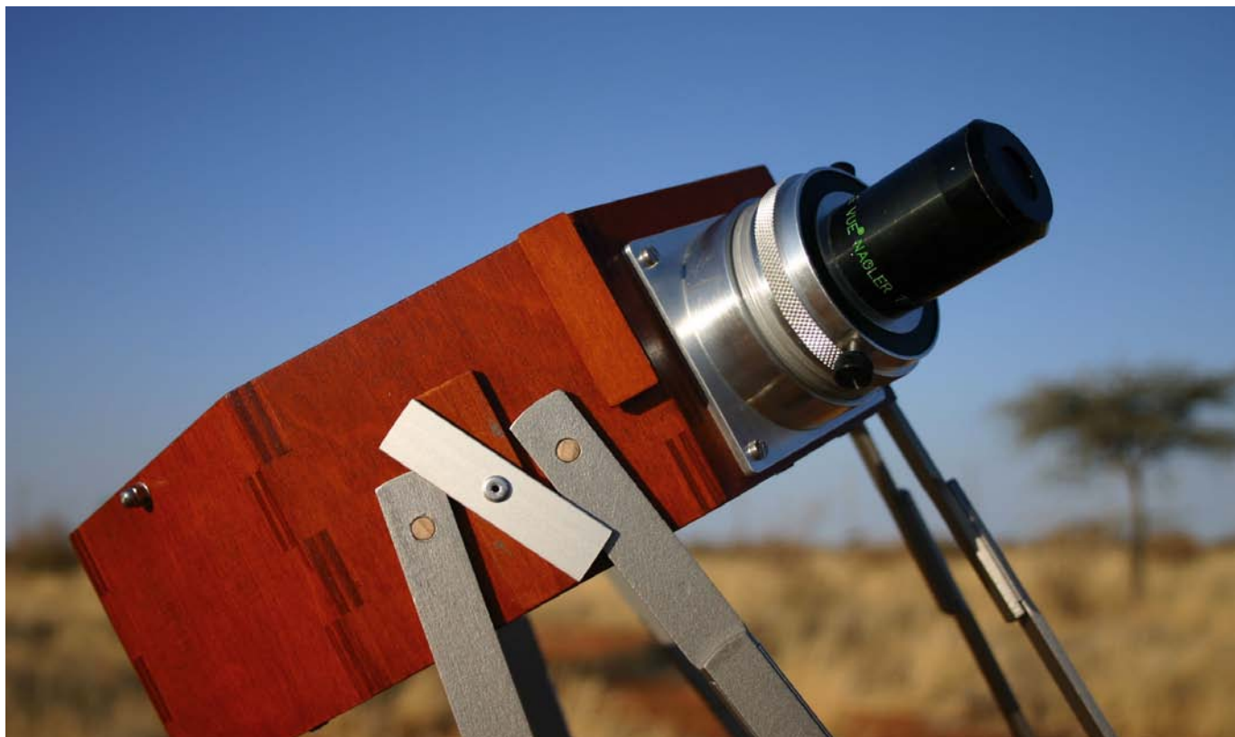
Abb. 2: Die Zollstockstreben werden spielfrei mit einem Metallriegel befestigt. Der 2"-Okularauszug ist für eine angenehme Einblickposition im Winkel von 45° angebracht.
