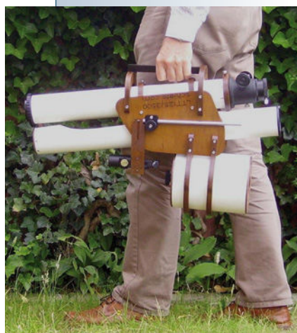
Abb. 2: Mit 6,5kg Gesamtgewicht und faltbarem Tubus ist der 5"-Schiefspiegler transportabler als mancher gleich große Refraktor.
