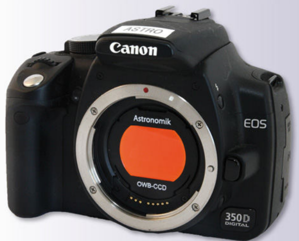
Abb. 6: Mit dem Astronomik-OWB-Filter erhält eine für die Astrofotografie modifizierte Canon EOS-Kamera ihre Farbbalance für Tageslichtaufnahmen wieder zurück.
