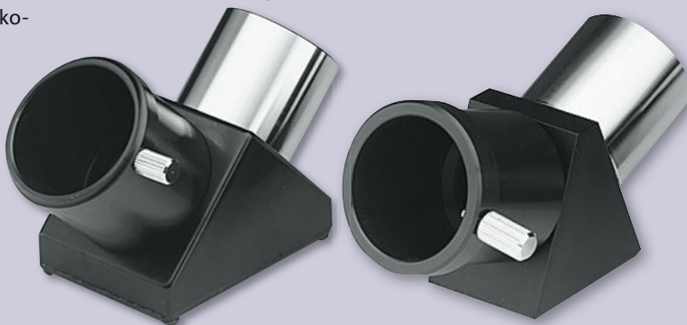
Abb. 2: Prismen werden für alle Teleskope mit Einblick am unteren Tubusende benötigt. Einem seitenvertauschenden Zenitprisma (links) sollte man ein um 180° drehendes Amicprima (rechts) vorziehen.
