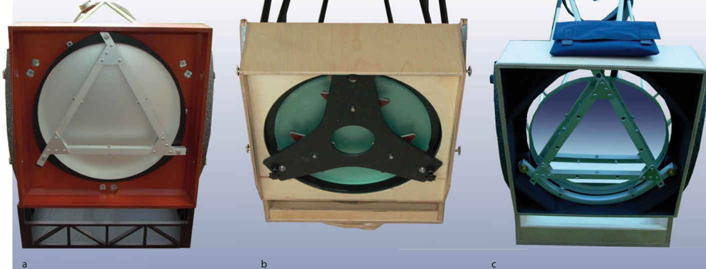
Abb. 5: Blick auf die Hauptspiegelaufhängung: Hofheim (a), Martini (b), Traveldob (c).
