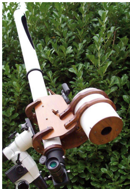
Abb. 1: 125mm Öffnung und 3500mm Brennweite vereint der Schiefspiegler von Lutz Liebers aus Bottrop.
