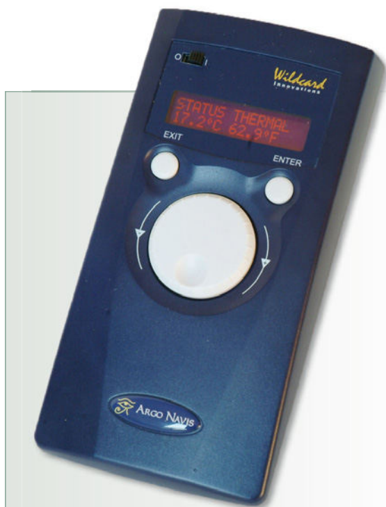
Abb. 1: Hilft Dobsons auf die Sprünge: Der Argo Navis-Teleskop-computer.
