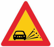
(K - 13) Επικίνδυνη εκτίναξη χαλίκων, (ασύνδετο αμμοχάλικο).
