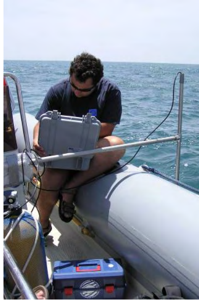
Figura 6.3 - Estrutura onde se encontravam montados os hidrofones na embarcação Recife II.
