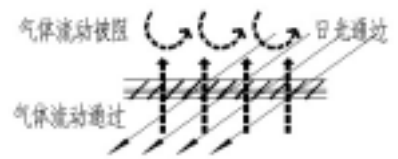
图7 单向流通式吊顶百叶
