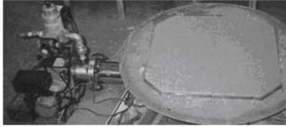
图3 锅炉用金属纤维燃烧器
