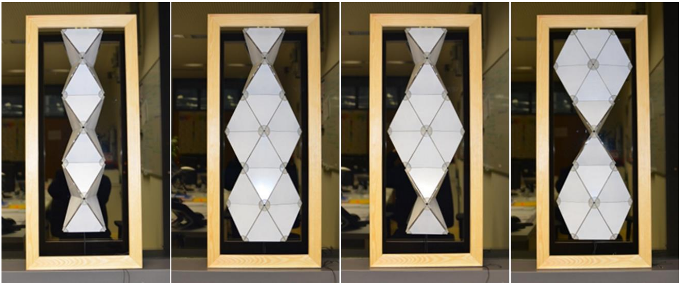
Bild 7: Demonstrator für ein adaptives Faltnetzwerk aus Plexiglasplatten mit drei in Reihe angeordneten sechsteiligen Faltelementen, die unabhängig voneinander einzeln gefaltet werden können. Im maximal gefalteten Zustand beträgt die verschattete Fläche nur 25% der Fläche im aufgeklappten Zustand.
