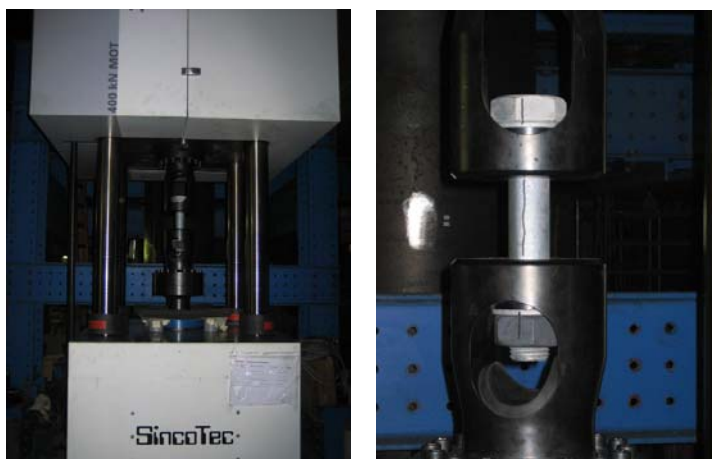
Abbildung 4-1: Resonanzprüfmaschine und Zugtorpedo für Axialschwingversuche
