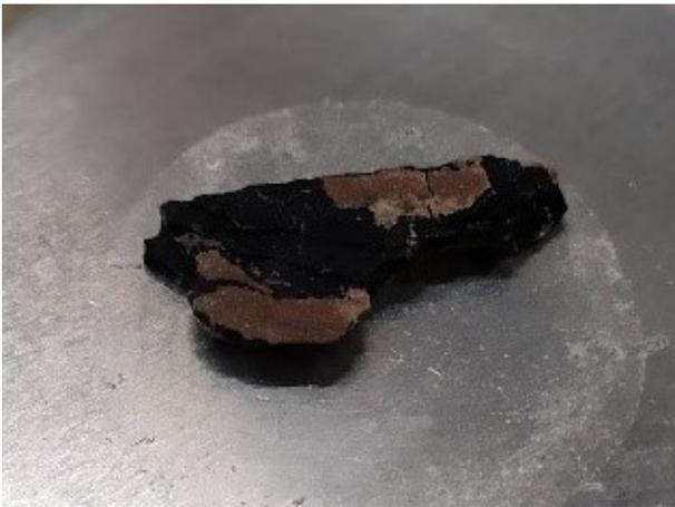
Abbildung 104: Foto Pechblende der Probe D
