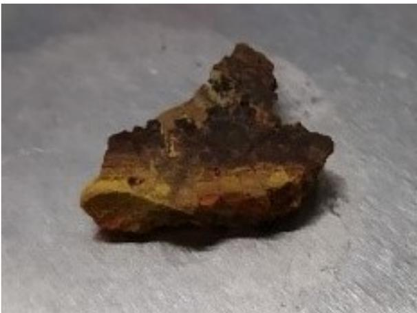
Abbildung 101: Foto Pechblende der Probe A
