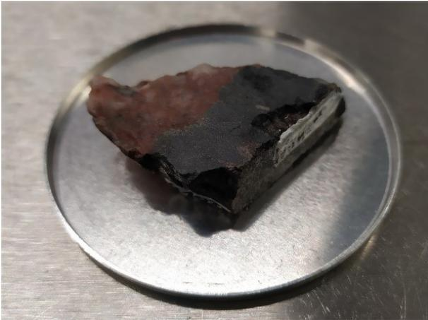
Abbildung 110: Foto Pechblende der Probe T
