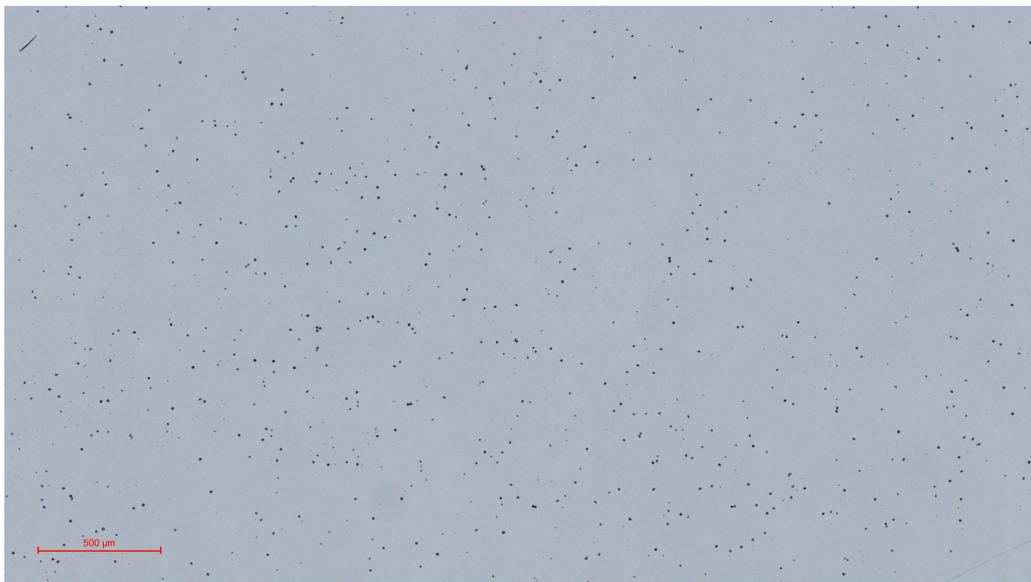
Abbildung 27: Mikroskopbild alpha-Track Detektor Probe B - Vergrößerung auf alpha-Tracks
