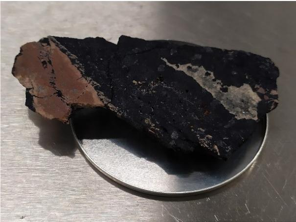
Abbildung 74: Foto Pechblende der Probe O
