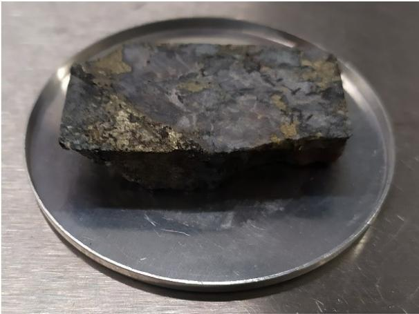
Abbildung 92: Foto Pechblende der Probe Y
