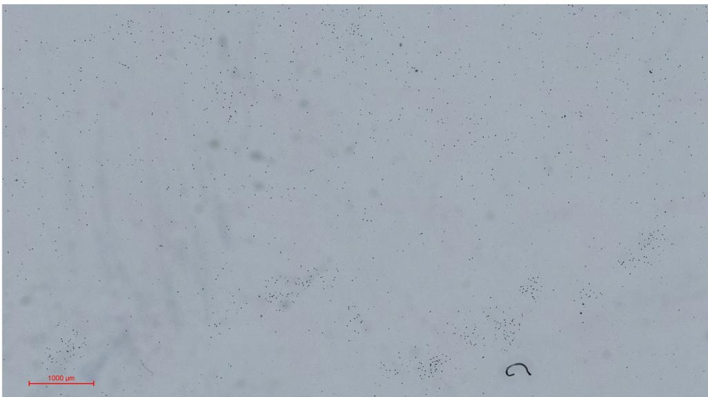
Abbildung 40: Mikroskopbild alpha-Track Detektor Probe R - Zoom auf Uraninit
