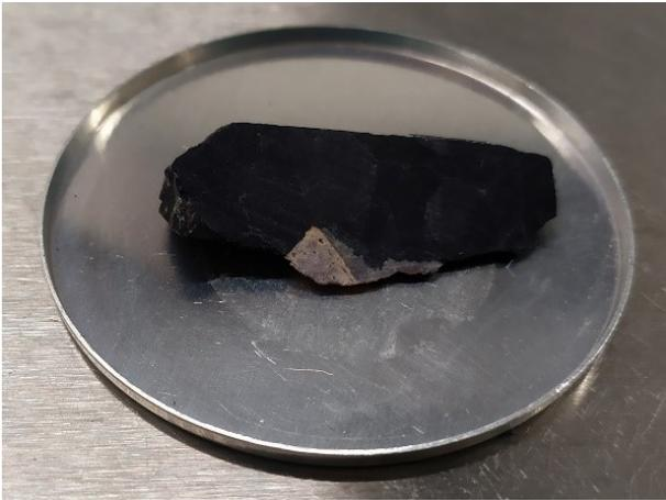
Abbildung 89: Foto Pechblende der Probe X
