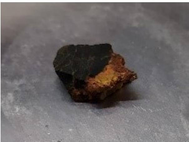
Abbildung 25: Foto Pechblende der Probe B
