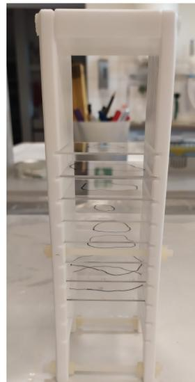
Abb. 3: Probenhalter aus Teflon für die alpha-Track Detektoren
