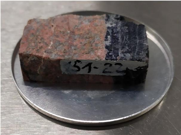
Abbildung 33: Foto Pechblende der Probe R
