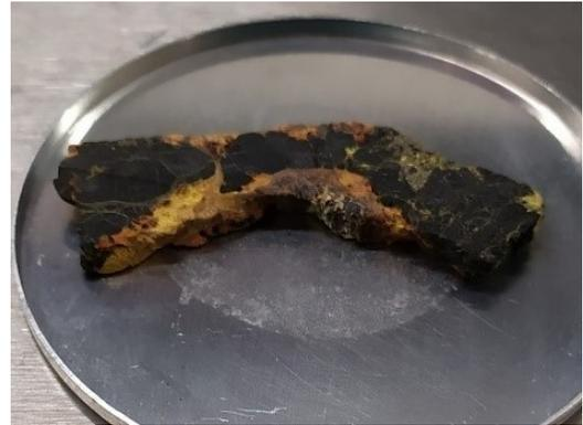
Abb. 1: Foto einer Pechblende-Probe
