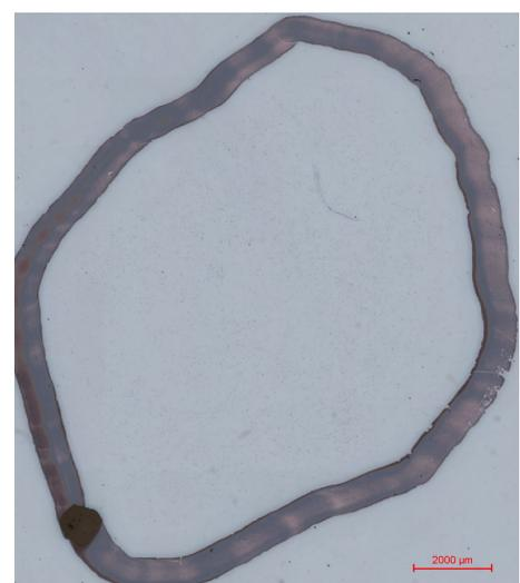
Abbildung 26: Mikroskopbild alpha-Track Detektor Probe B
