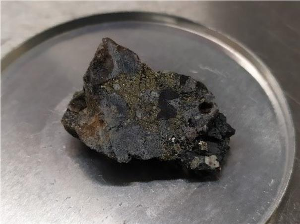
Abbildung 116: Foto Pechblende der Probe Z
