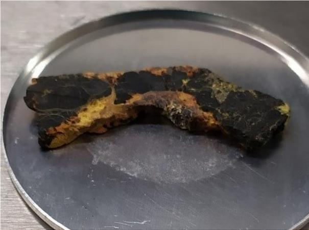
Abbildung 107: Foto Pechblende der Probe M
