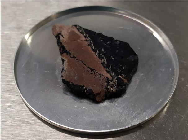
Abbildung 38: Foto Pechblende der Probe Q
