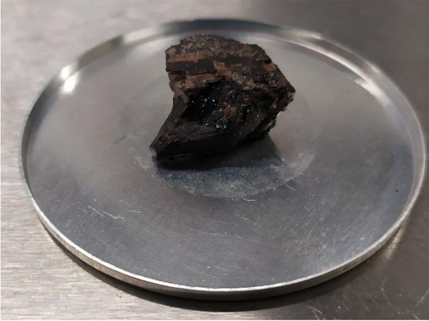
Abbildung 119: Foto Pechblende der Probe AC
