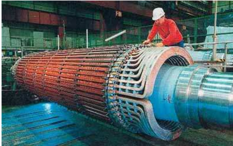
Abbildung 3.16: Innenleben eines Kraftwerkgenerators
