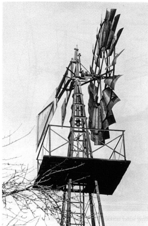
Abbildung 7.5: Meistverkaufte windgetriebene Wasserpumpe in den USA Typ: Eclipse nach R.L. Wheeler [33]
