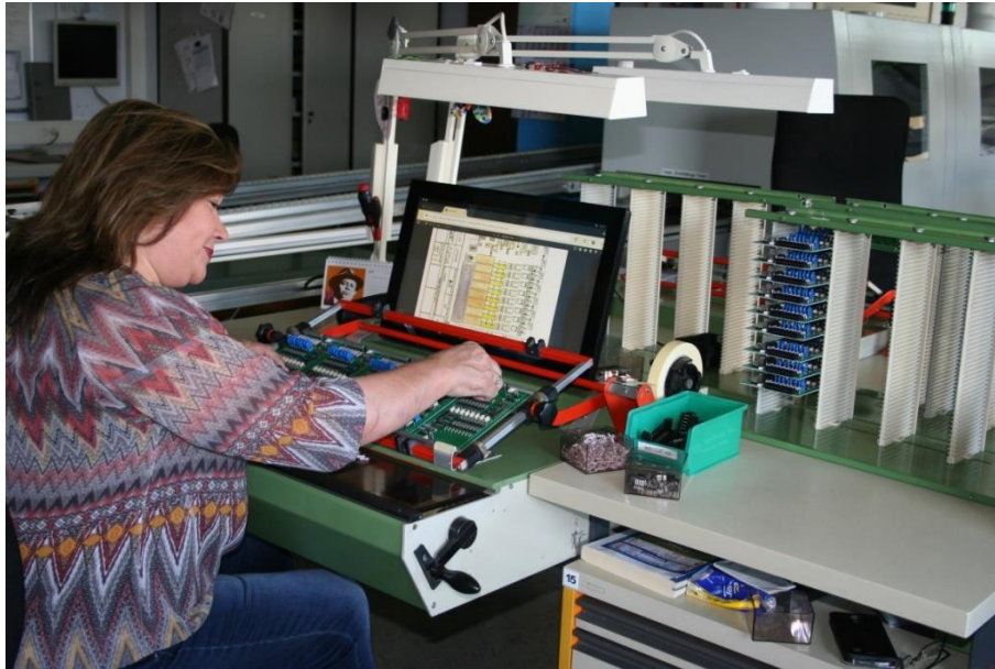
Abbildung 35: THT Arbeitsplatz mit Monitor
