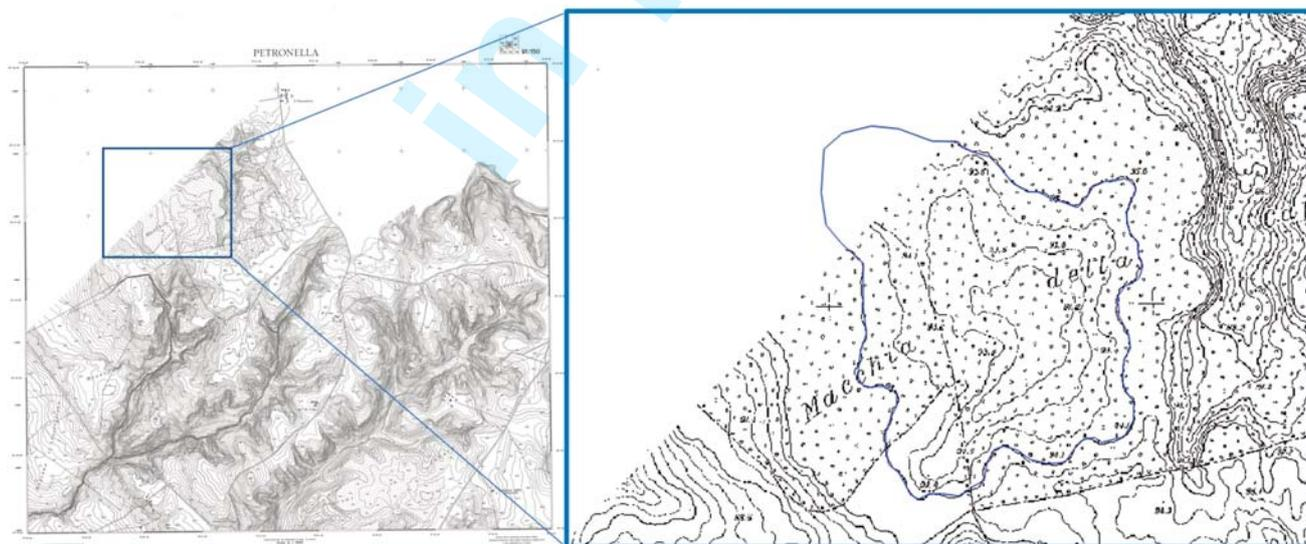
Fig. 14 - Stralcio della carta topografica prodotta per conto dell'Opera Nazionale Combattenti - ONC - Tavoleta "Petronella" 91/150 (Istituto di Rilievi aerei e Terrestri SA, 1937) in scala 1:5000, con equidistanza delle curve di livello ogni metro. In blu è stato sovrapposto il perimetro del *Lacus Turni*, il cui limite nord-orientale ricade leggermente fuori dall'area assegnata all'ONC che quindi non è stata cartografata.
