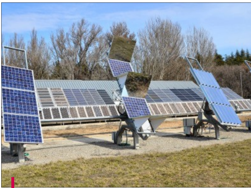
Cette centrale intégrera la technologie "tracker", étudiée notamment au CEA Cadarache (notre photo): les panneaux suivent l'axe du soleil pour plus de rendement.
