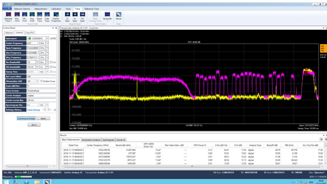
Recepción de dos polarizaciones diferentes (Nota: Polarización principal = Traza amarilla, Polarización transversal = Traza púrpura)
