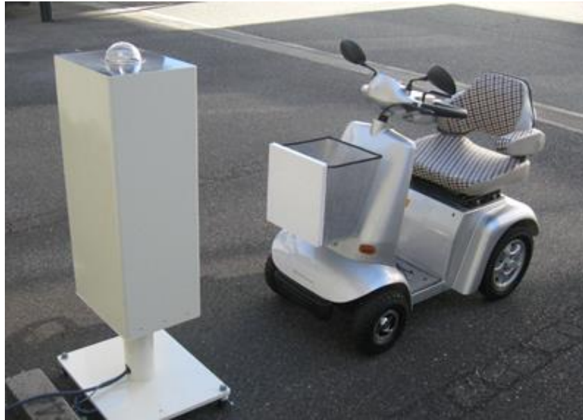
Sistema de carga inalámbrica para un pequeño vehículo eléctrico
