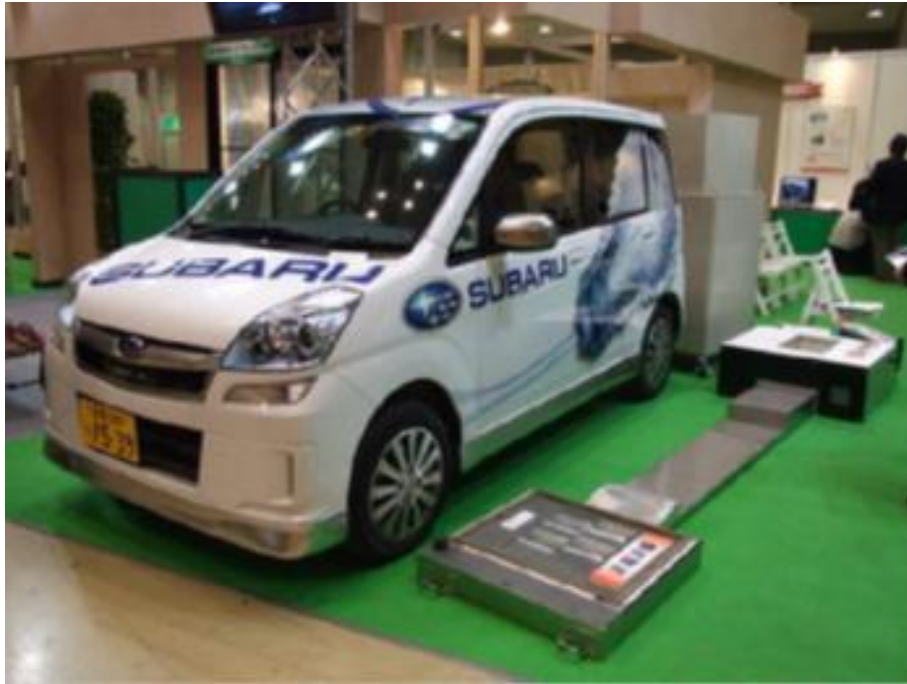
FIGURA 32 Experimento de carga inalámbrica por microondas del Grupo Mitsubishi Heavy Industries en 2009 [SHI 13-2]
