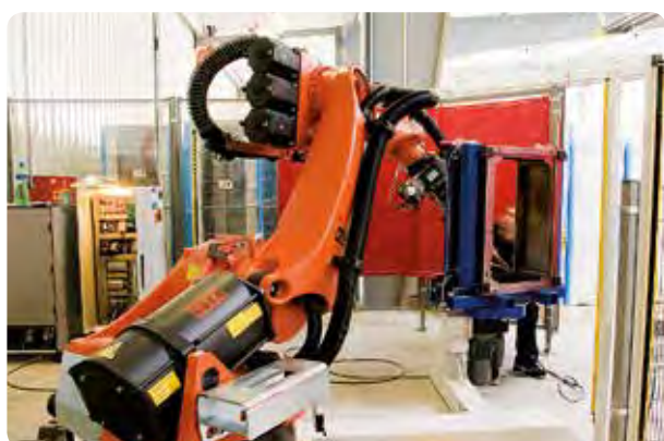
Punktschweißroboter für Wandgehäuse
