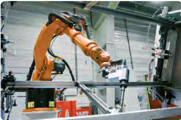
Schweißroboter für Standverteiler
