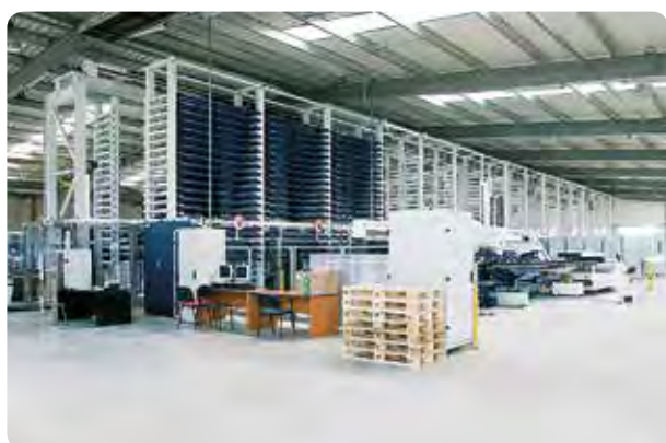
Automatisches Blech- und Halbfabrikatlager
