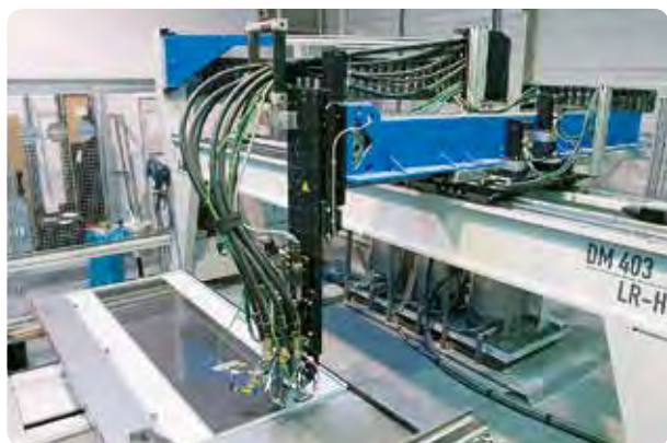
Zentrum zum Einkleben des Türglases und Fertigung der Türdichtungen
