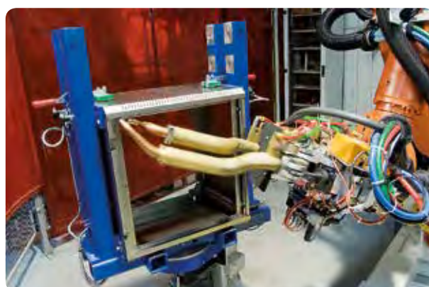
Punktschweißroboter für Wandgehäuse
