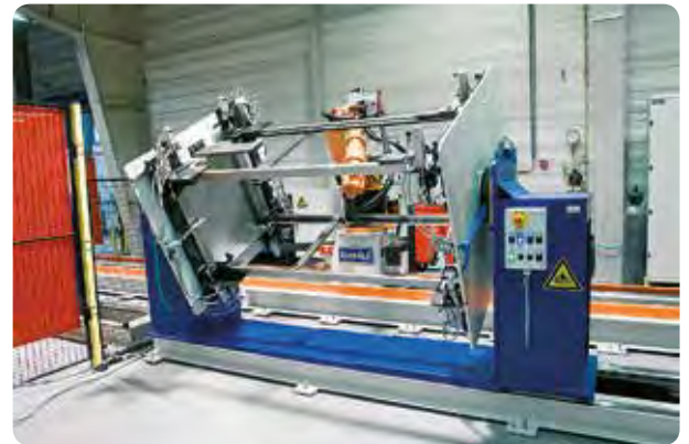
Schweißroboter für Standverteiler
