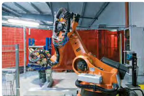
Punktschweißroboter für Wandgehäuse
