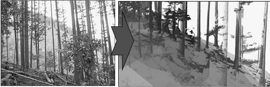
▲図③ 調査林分写真(左)とレーザデータから再現した樹木位置図
