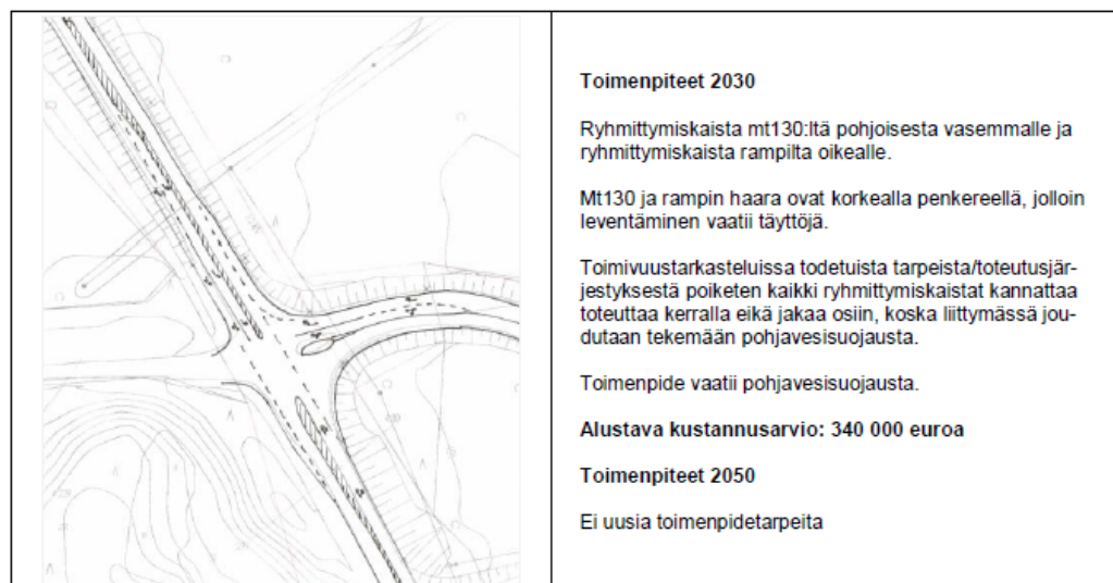
Kuva 17. Toimenpidetarpeet mt 130 ja 292 liittymän rampissa, mt 130.
