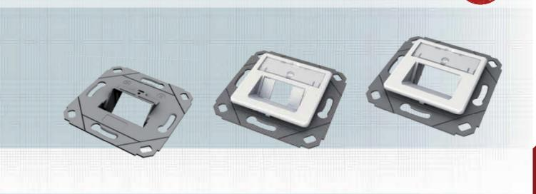
Die designfähige Modulaufnahme besteht aus einen Zinkdruckguss-Rahmen. Sie eignet sich für den Einbau in einen Kabelkanal (EK), für Unterputzmontage (UP) oder mittels separatem Rahmen auch zur Aufputzmontage (AP). Durch das Wegbrechen von zwei Montagelaschen ist auch eine Bodentankmontage (BT) möglich. Die designfähige Datendose ist mit nahezu allen am Markt erhältlichen Schalterprogrammen kombinierbar.
