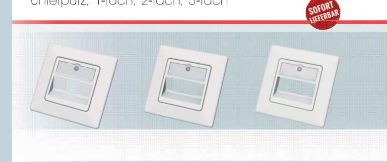
Die Modulaufnahmen SL sind besonders für den Einbau im Kabelkanal (EK), die Unterputzmontage (UP) und zur Aufputzmontage (AP) geeignet. Durch das Wegbrechen von zwei Montagelaschen ist auch eine Bodentankmontage (BT) möglich. Die Modulaufnahme SL kann ein bis drei EasyLan-Keystones absolut sicher und dauerhaft aufnehmen. Sie besitzt ein großes, zentral befindliches Beschriftungsfenster für eine einfache Kennzeichnung.
