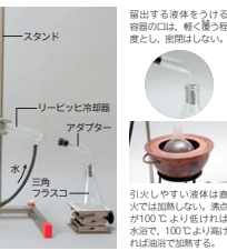
蒸気の温度を測るため、温度計の球部はフラスコの枝の高さに合わせる。
