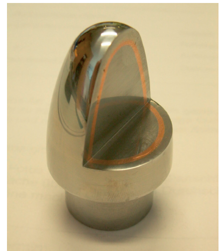
Abb. 3: Versuchsbauteil mit Kupfer Zwischenlage
