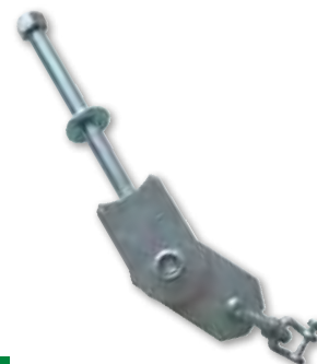
23 24 Schwinghaken verzinkt mit Kugellager in einer 10 mm dicken Stahlplatte. Nylonlager (außen Ø 15 mm, innen Ø 6 mm) für die Befestigung von Ketten, Gesamtlänge 120 mm/160 mm, Gewindestange mit M14-Sicherheitsmutter, Schäkel mitgeliefert.
