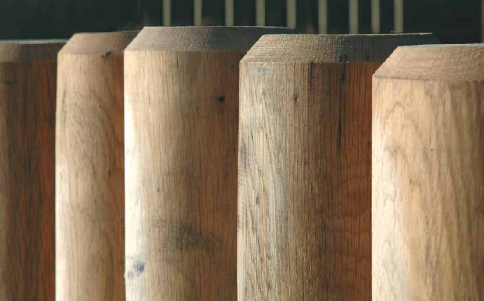
Palisaden, naturbelassen, im Prinzip splintfrei, gefräst, gefast. Das Kernholz ist sehr witterungsbeständig
