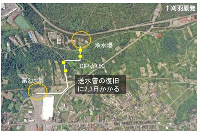
図-71 斜面上での送水管路被害箇所
