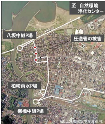
図-78 下水幹線図と圧送管の被害箇所
