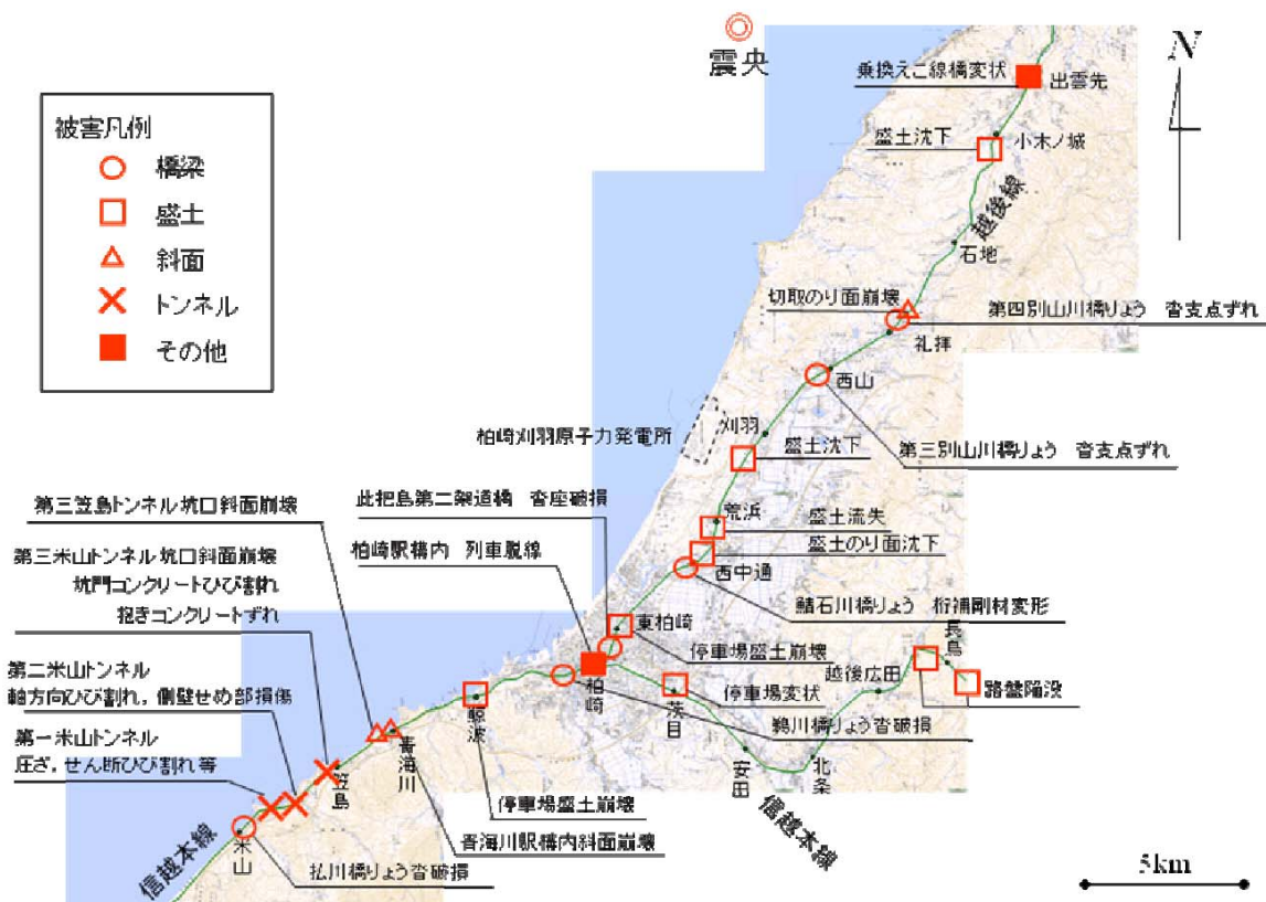
図-116 新潟県中越沖地震の鉄道施設の主な被害 39)
