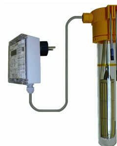
Vollautomatische digitale Quarzglas Groß-Badwärmer mit am Anschlusskopf montierter Trockenheizschutz-Elektrode, Temperaturfühler/Temperaturbegrenzer-Elektrode, mit Schuko-Stecker-Gehäuse. Siehe Katalog Seite 29
