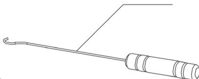
Verwenden Sie den Hebegriff (H) um das Funkenschutzgitter (G) an der Schrauböse (I) von der Feuerschale (B) zu heben bzw. um es wieder aufzusetzen.
