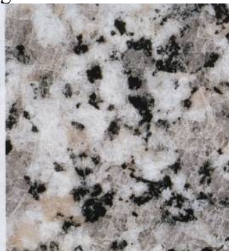
El granito es una mezcla heterogénea de tres sólidos (cuarzo, feldespato y mica).
