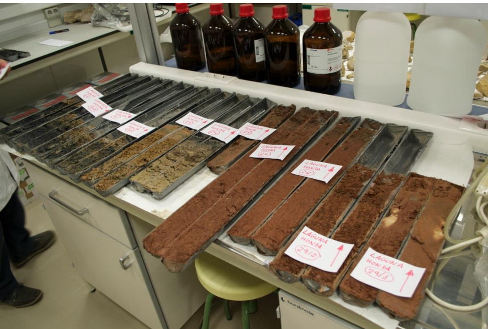
Figura 2.- Selección de testigos de sondeo cortados para su descripción y muestreo. Los situados a la izquierda, tomados en el interior de la laguna, destacan por su color negro y elevado contenido en materia orgánica.
