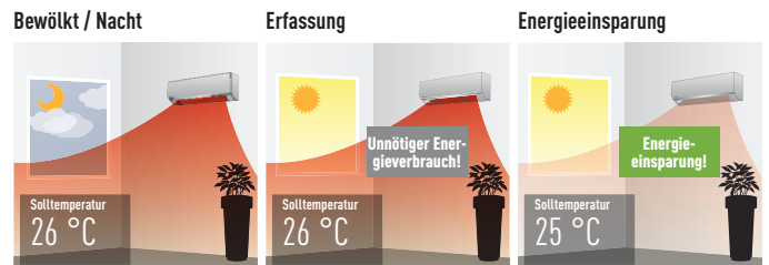
Econavi wird bei bewölktem Wetter oder Nacht eingeschaltet. Econavi ermittelt einen geringeren Heizbedarf. Die Heizleistung wird durch Absenken der Solltemperatur um 1 Grad reduziert.
