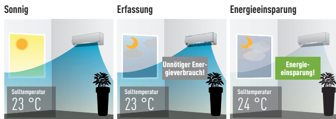
Econavi wird bei sonnigem Wetter eingeschaltet. Econavi ermittelt einen geringeren Kühlbedarf. Die Kühlleistung wird durch Anheben der Solltemperatur um 1 Grad reduziert.
