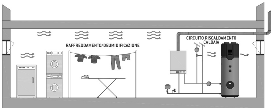
Warmwasserwärmepumpe in Sanitäranlagen mit einem Wand-Gasheizkessel
