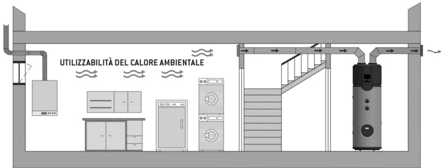
Warmwasserwärmepumpe mit Luftleitungen (Zufuhr-Luft - Abgabe-Luft)
