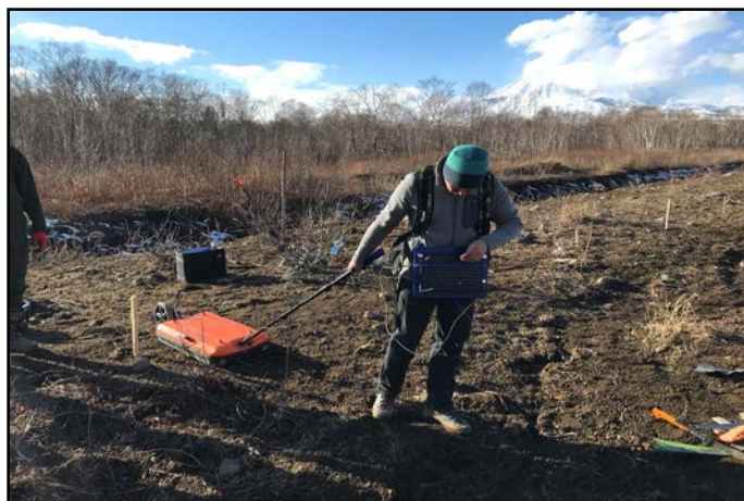
Рис. 85. Обследование тела Козельского полигона с использованием георадара.
