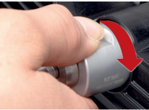
Εικόνα 11: Για την ασφάλιση πιέστε την κεφαλή ελέγχου και στρέψτε την προς τα δεξιά
