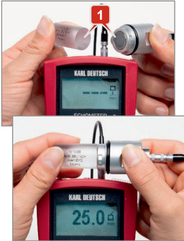
Εικόνα 15: Μέτρηση από το σώμα ελέγχου ως τακτική μέτρηση ελέγχου
