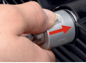
Εικόνα 10: Αντικατάσταση της κεφαλής ελέγχου
