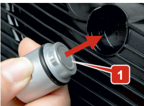
Εικόνα 9: Κεφαλή ελέγχου πριν την τοποθέτηση στην υποδοχή του δοχείου λαδιού μετάδοσης κίνησης
