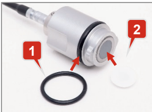
Εικόνα 8: Ώψη της κεφαλής ελέγχου με δακτύλιο O (1) και στρογγυλό δίσκο προστασίας (2)
