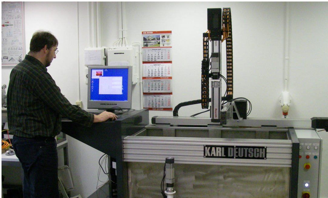
Bild Tauchtank zur Reinheitsgradprüfung. Wassertank mit Prüfkopfhalterung, die in 3 Achsen bezüglich zum Werkstück verfahren werden kann.
