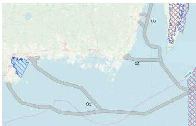
Kartan redovisar med grå markering undersökningskorridorer för ny sjökabeln till Ölands vindkraftpark, en planerad vindkraftpark sydost om Öland.
