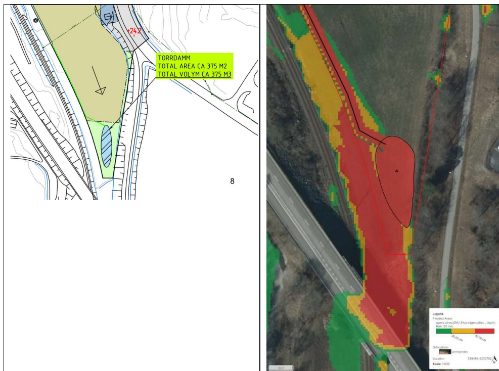
Figur 11. Föreslagen dagvattenlösning enligt Norconsult i södra delområdet (torrdamm), bild i vänster. Bild i höger visar översvämningssituation vid 100 års regn med 375 m 3 dammvoly.
