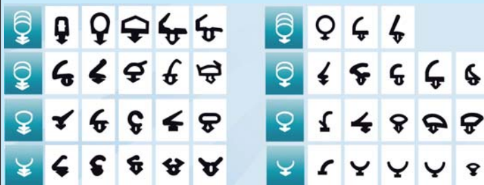
Profilerschnitte – durch einfaches Abtrennen der einzelnen Profilflagen erhalten Sie Ihre gewünschte Dichtung für die meisten Kunststofffenster und -türen.
