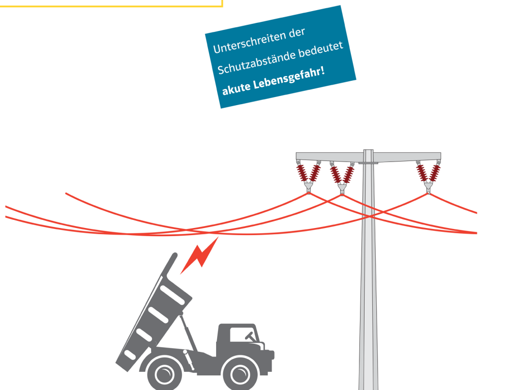
Abbildung 4: Berühren einer 20 kV-Leitung beim Entleeren eines LKW
