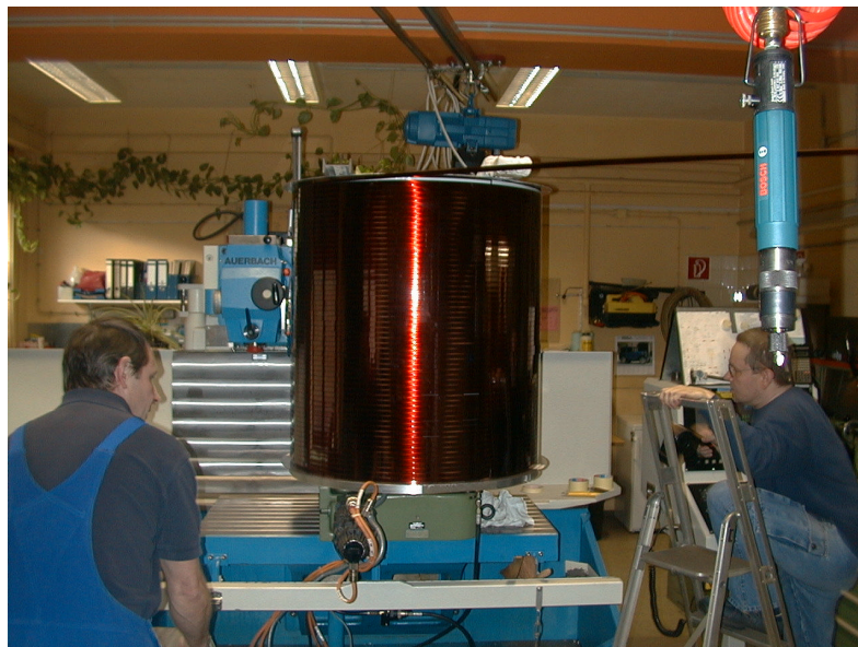
Abbildung 32. Solenoid für die NEG-Beschichtung.
