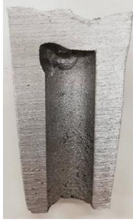
75. ábra Előkísérleti öntvényben ( h_{\text{olvadék}}=30 \text{ mm} ) található maggáz okozta meggörbített határfelület
