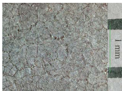
Abb. 66: Aufnahme der Mikrorisse vor der Reinigung (USB Digital-Mikroskop-Kamera eScope DP-M07, Vergrößerung bei der Aufnahme: 250 x).
