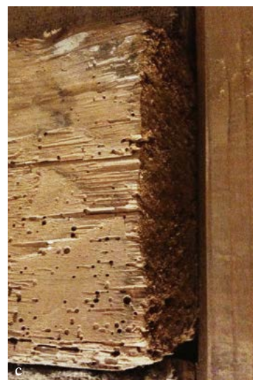
Abb. 41: a. Detail der oberen ergänzten Gratleiste. b. Seitenansicht der Gratleiste an der rechten Seitenkante (waagrecht verlaufende Jahrringe). c. Seitenansicht der unteren originalen Gratleiste an der rechten Seitenkante (senkrecht verlaufende Jahrringe).
