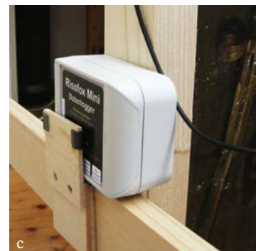
Abb. 51: a. bis c. Bewegungsmessung mit dem Potentiometer (Rissfox®).
