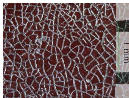
Abb. 68: Aufnahme der Mikrorisse nach der urushigatame -Behandlung (USB Digital-Mikroskop-Kamera eScope DP-M07, Vergrößerung bei der Aufnahme: 250 x).
