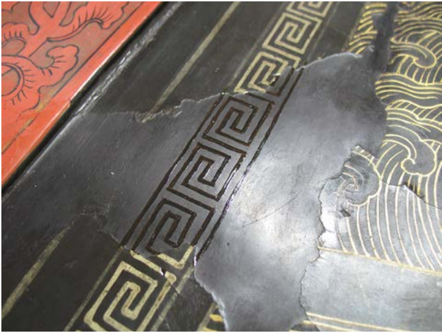
Abb. 86: Auftrag von Leinöl-Mixtion auf einer Wachsergänzung.
