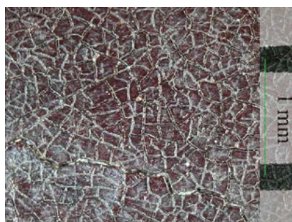
Abb. 67: Aufnahme der Mikrorisse nach der Reinigung (USB Digital-Mikroskop-Kamera eScope DP-M07, Vergrößerung bei der Aufnahme: 250 x).
