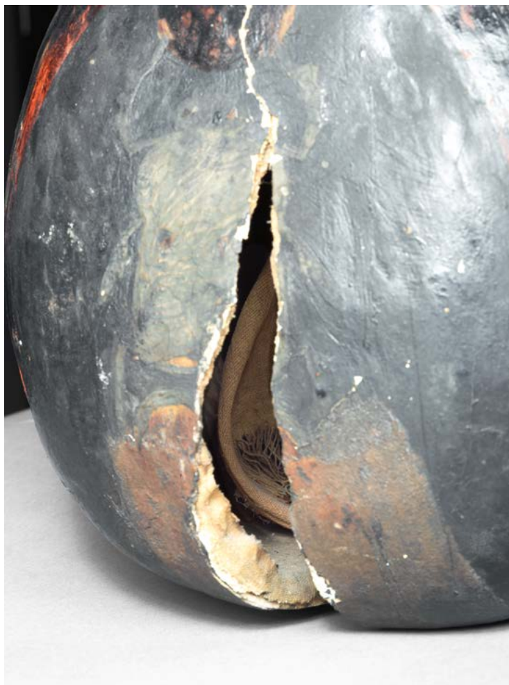
Abb. 10: Inv.-Nr. ÄS 3942, Mehrschichtigkeit der Kartonage, Überlappung des Stoffes im Scheitelteil.
