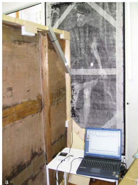
Abb. 51: a. bis c. Bewegungsmessung mit dem Potentiometer (Rissfox®).
