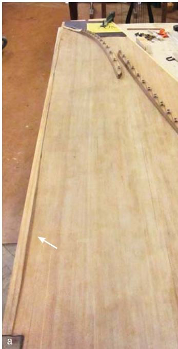
Abb. 8: Schadensbilder des Resonanzbodens. a. Stauchriss an der langen Wand. b. Abgelöste Rippen. c. Schwundrisse im Diskant.
