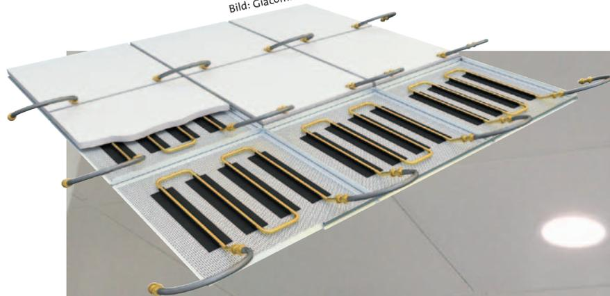
◀ Die GK-PSV-Platten mit Typ-C-Aktivierung aus verzinktem Stahlblech verfügen über vier werkseitig aufgeklebte Luftleitbleche aus eloxiertem Aluminium mit 75 mm Breite. Das Wasser wird über ein Register mit Kupferrohrschlange umgewälzt.
