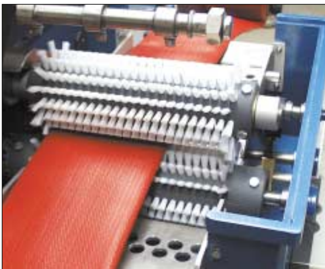
(Abb.: Französische Ausführung mit Wickleinrichtung für 40 m lange A 110 Schläuche)
