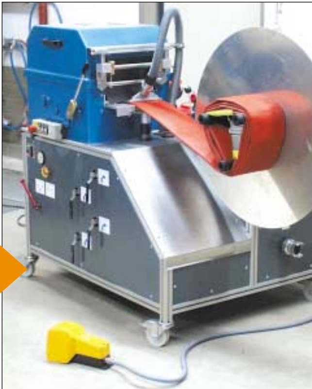
(Abb.: Französische Ausführung mit Wickleinrichtung für 40 m lange A 110 Schläuche)
