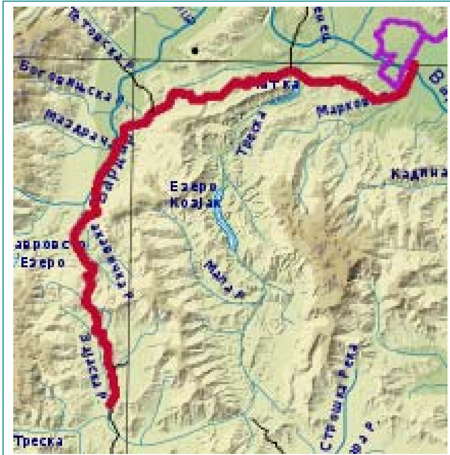
Слика бр.26: Сливните подрачја на реките низ кои поминува трасата од гасоводот
